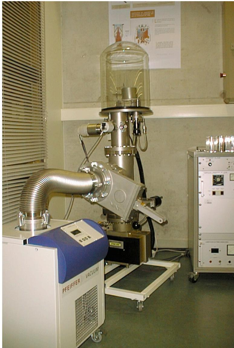
*Filament du tungstène porté à l'incandescence pour la vaporisation de l'aluminium*
